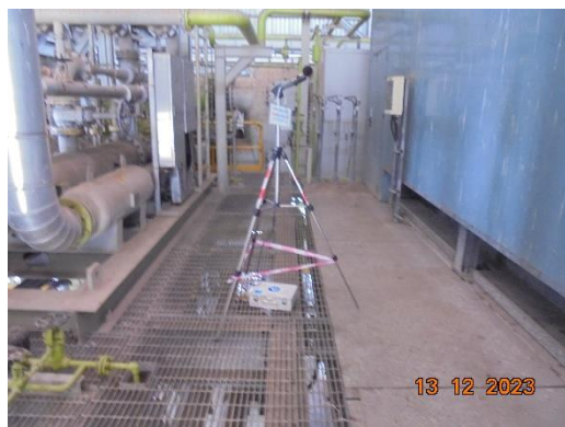
ภาพที่ 3.6-1 แสดงการตรวจวัดระดับเสียงในบริเวณการทำงาน ระหว่างเดือนกรกฎาคม-ธันวาคม พ.ศ. 2566
