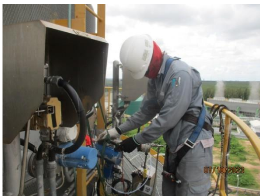
ภาพที่ 3.2-1 แสดงการตรวจวัดคุณภาพอากาศจากปล่องระบาย ในวันที่ 7 ตุลาคม พ.ศ. 2566
