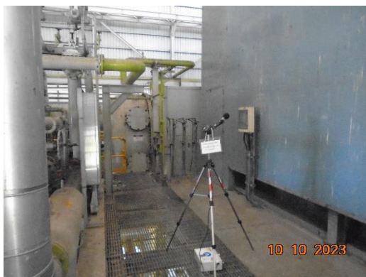
ภาพที่ 3.6-1 แสดงการตรวจวัดระดับเสียงในบริเวณการทำงาน ระหว่างเดือนกรกฎาคม-ธันวาคม พ.ศ. 2566
